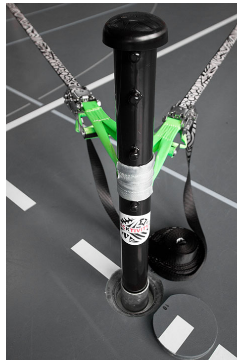
I pali dello slacklining sopportano forti trazioni durante l'attività. Vanno installati nei fori previsti per i pali della sbarra, di pallavolo o i pali delle porte di pallamano.
