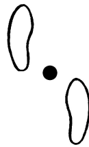
Abb. 26 Das Lot fällt durch das Zentrum der Standfläche.
